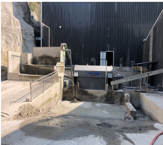
图 5-7 已设置的混凝土砂石机分离机
