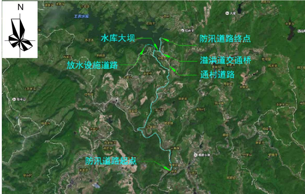
图 2-5 防汛道路平面布置示意图
